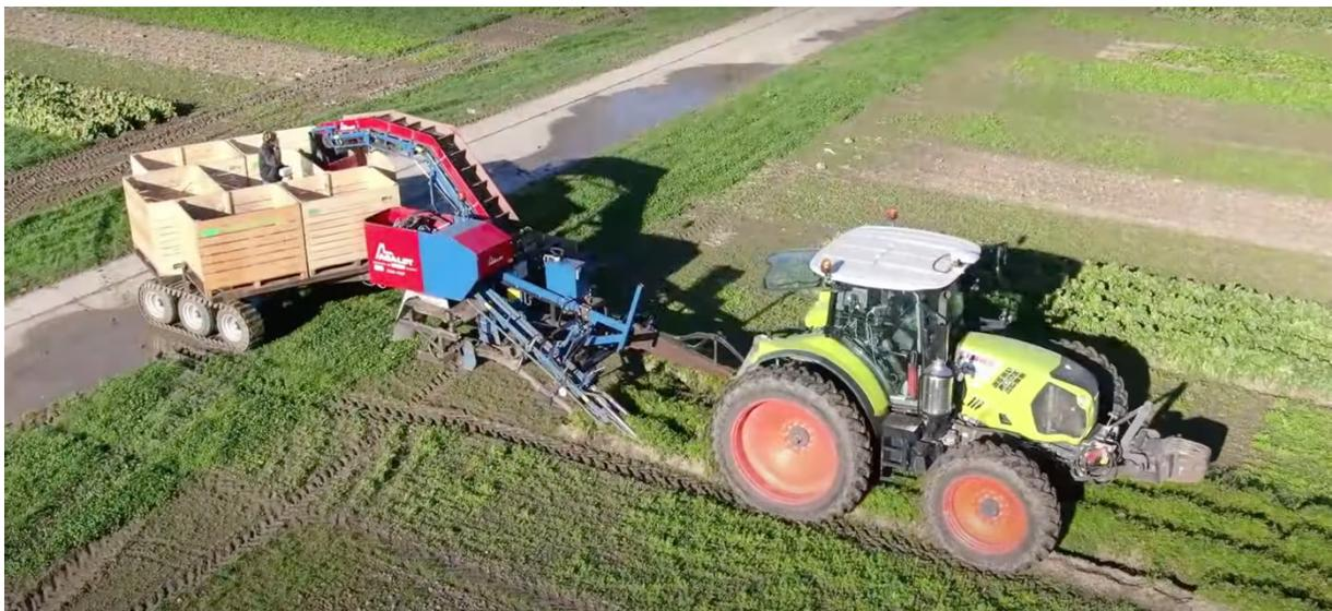
*Abbildung 3: Karottenernte in 3 Meter breiten Streifen mit 3,20 Meter breiter Fahrspur im Controlled-Traffic-System auf einem Betrieb in den Niederlanden ©Bi-Jovira*
