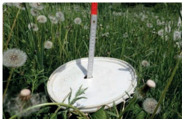
Abb. 3: Um die Aufwuchshöhe zu messen, ist die sogenannte „Deckelmethode“ hilfreich
