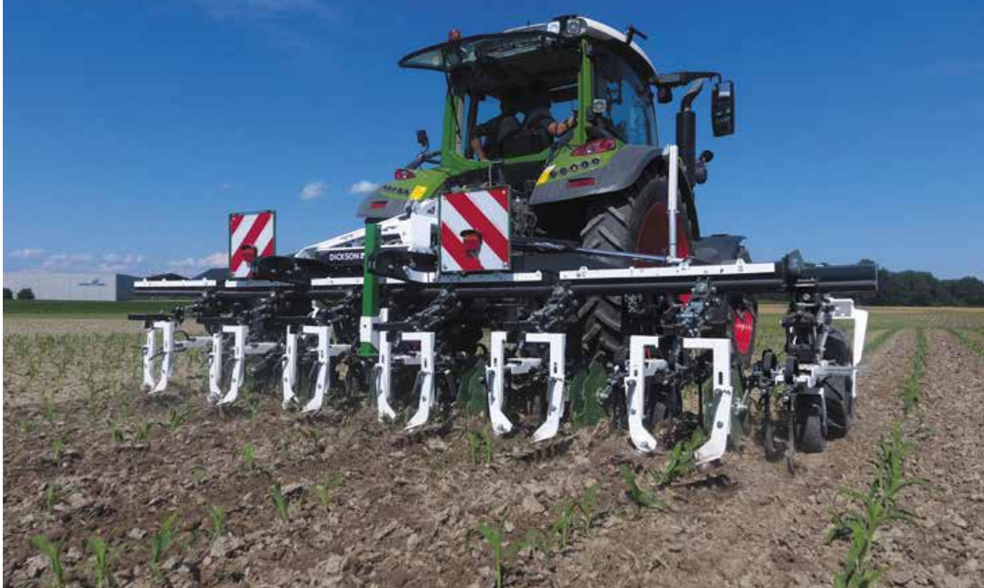
Die Besonderheiten des Variofield-Hackgeräts sind neben dem zweibalkigen Aufbau die Modulbauweise sowie die komplett werkzeuglosen Verstellmöglichkeiten.
