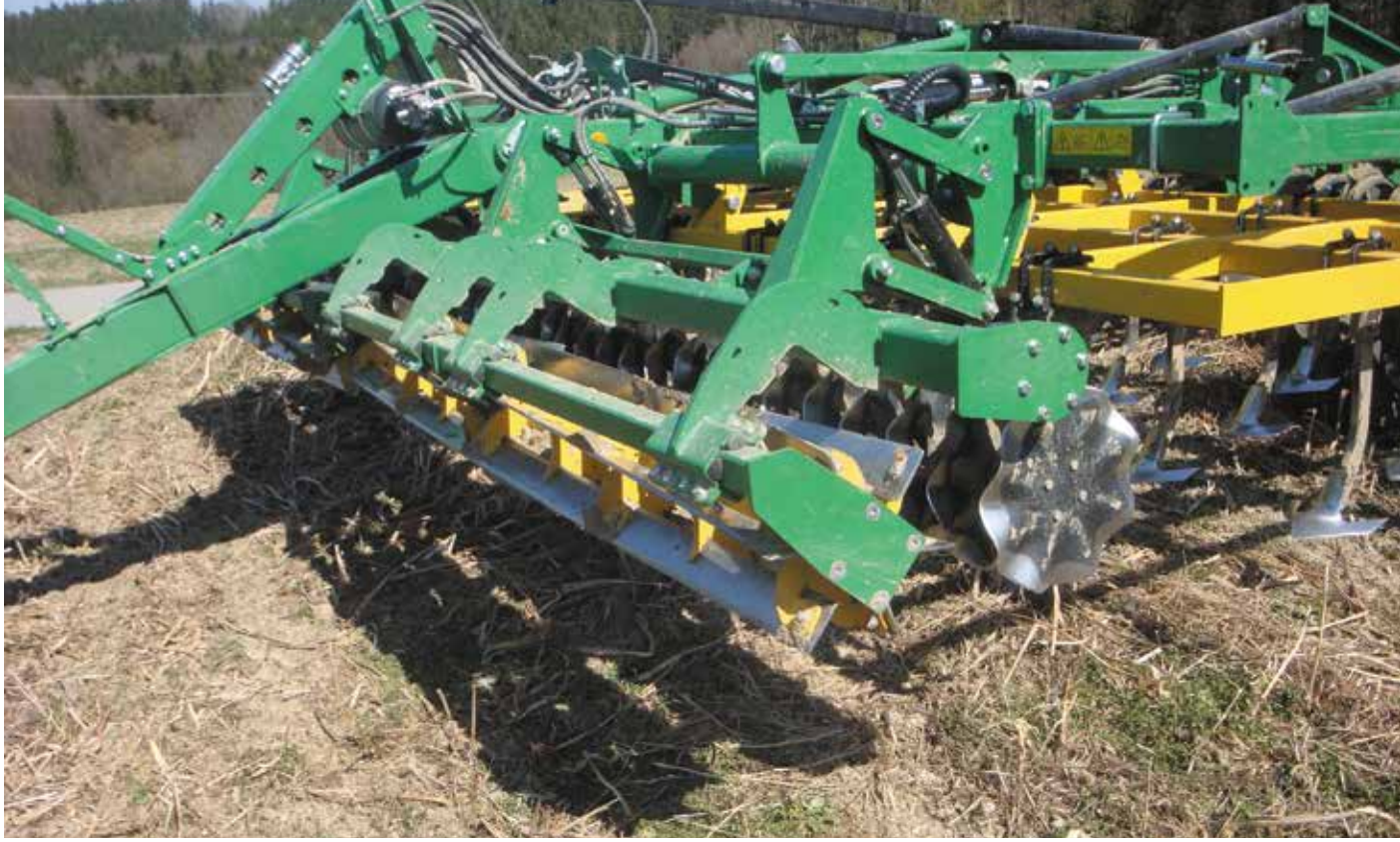
Der Flachgrubber Stratos von Kerner ist mit einer Messerwalzenkombination ausgestattet, auf die sich das Gerät vorne zur Tiefenführung abstützt.
