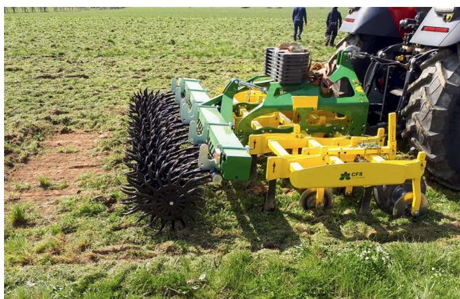
*Das Unterschneidergerät der Fa. CFS hinterlässt eine fast vollständige Bodenbedeckung. Durch die ungenügende Enterdung der Wurzeln besteht jedoch die Gefahr des Wiederanwachsens der Begrünung.*
