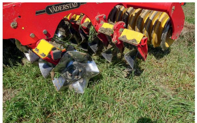
*Bei abgefrosteten Begrünungen und wenig Beikrautdruck kann auch die Kurzscheibenegge für eine effiziente Frühjahrsbearbeitung eingesetzt werden. Stark gewellte Scheiben begünstigen die ganzflächige Bearbeitung.*
