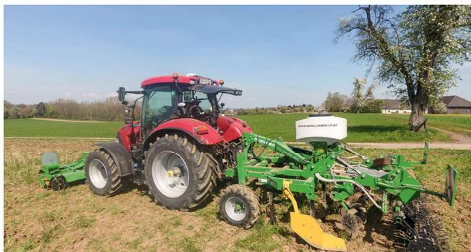
*Sogenannte Exaktgrubber sind für die „ultraflache Bearbeitung“ mit Tiefenführungsradern und Gänsefußscharen ausgestattet. Bei angebauten Geräten kann dabei auf das Nachlaufgerät verzichtet werden bzw. mit Striegelwerkzeugen ersetzt werden.*
