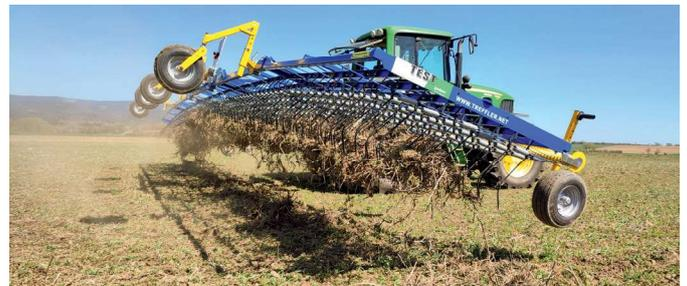
Der Einsatz von Hackstriegeln ist bei größeren Mulchmengen meist nicht möglich
