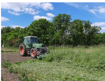
Direktsaat von Mais mit Quetschwalze (Roller Crimper)
