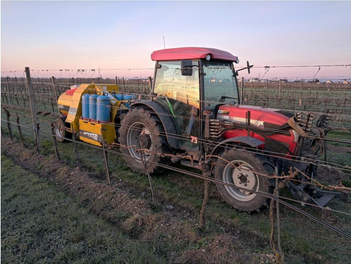
Abbildung 23: Von einem Traktor gezogener FrostBuster.
