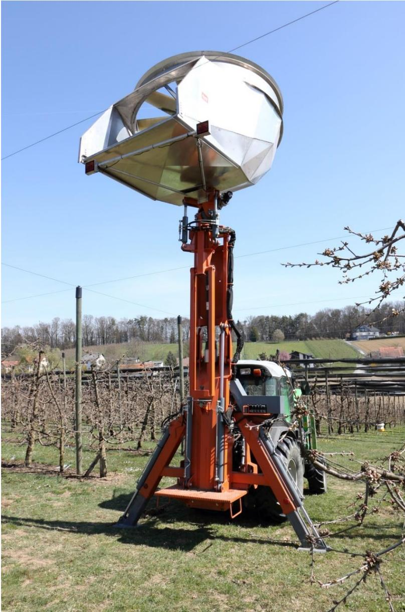
Abbildung 18: Mobile Windmaschine der Firma Rath
