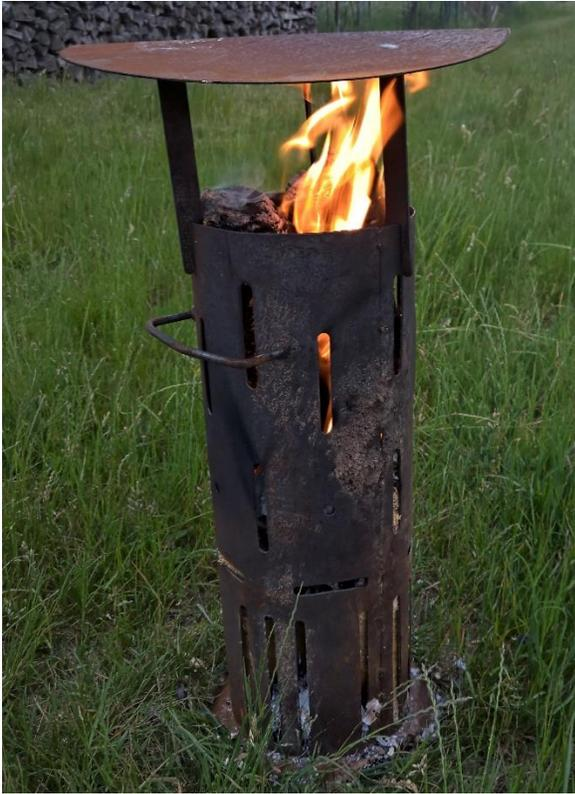
Abbildung 10: Frostschutzofen für Holzbriketts mit aufsetzbarem Hut
