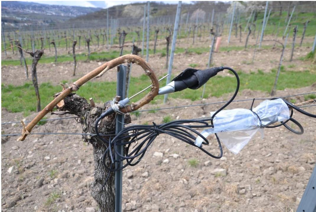
Abbildung 17: „Nadelsensoren“ auf der Oberfläche und innerhalb der Rebe
