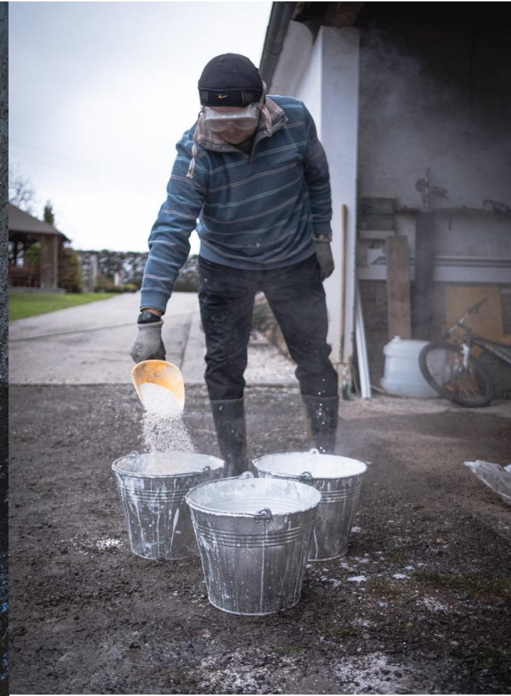
Kalk-Gülle-Gemisch am Boden des Vorlagebehälters und Ablöschen des gekörnten Kalks: © LK Steiermark, P. Zenger
