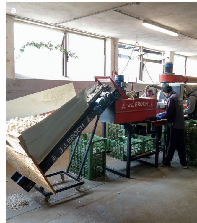
Abb. 10: Maschinelles Zerteilen der Knoblauchzwiebeln. Die ganzen Zwiebeln werden mechanisch aufgebrochen (a), die Zehen händisch vereinzelt und nachsortiert (b). Die Zehen sollten im Anschluss möglichst wenige Beschädigungen aufweisen (c) (Fotos: K. Gasser, BOKU (a, b); J. Keferböck, LKNÖ (c)).
