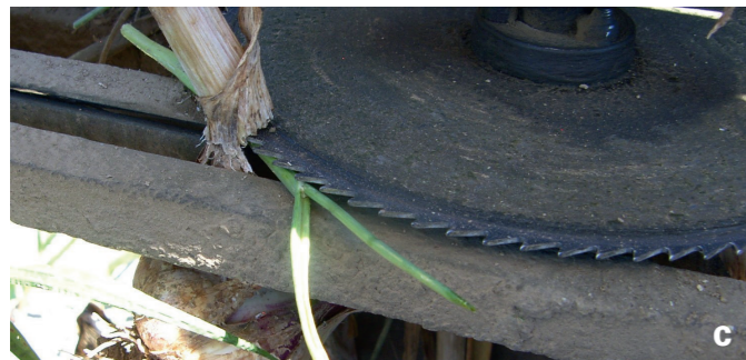
Abb. 18: Knoblauchernte mit dem Klemmbandroder: Der Boden wird gelockert (a), die Pflanzen werden am Laub aus dem Boden gezogen (b), die Zwiebel wird vom Laub getrennt (c) und in einen Transportbehälter abgelegt (d) (Fotos: J. Keferböck, LKNÖ).
