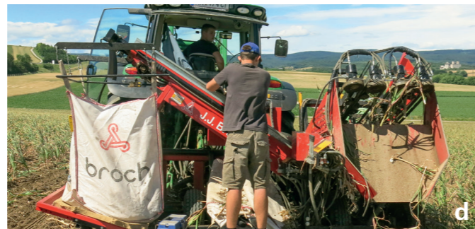
Abb. 18: Knoblauchernte mit dem Klemmbandroder: Der Boden wird gelockert (a), die Pflanzen werden am Laub aus dem Boden gezogen (b), die Zwiebel wird vom Laub getrennt (c) und in einen Transportbehälter abgelegt (d) (Fotos: J. Keferböck, LKNÖ).
