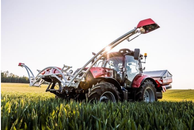
Abbildung 11: ISARIA-Sensor (Quelle: Innovation Farm)
