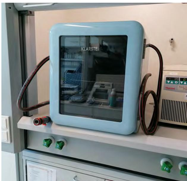
Abbildung 43: Umgebauter Kühlschrank für Gasversuche
