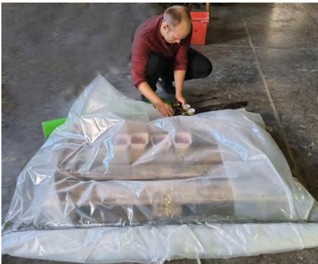
Abbildung 45: Verschließen der Folien und Einleiten des Gases.
