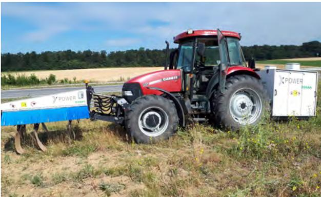
Abbildung 40: Zasso Gerät (Elektrische Behandlung)
