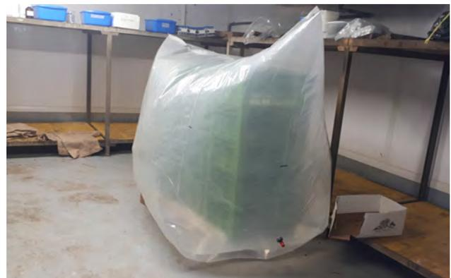
Abbildung 46: Nach dem Einleiten des Gases wurden die Versuchspaletten in den Kühlraum transportiert.
